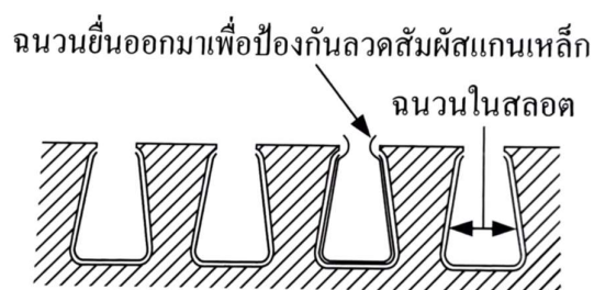
รูปที่ 6.5 การใส่ฉนวนเพื่อป้องกันลวดทองแดงสัมผัสกับปากสลอต
