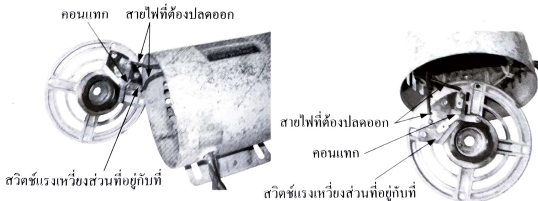
รูปที่ 2.9 ฝาปิดท้ายและหน้าคอนแทคของสวิตช์แรงเหวี่ยงที่มีสายไฟฟ้าต่ออยู่
