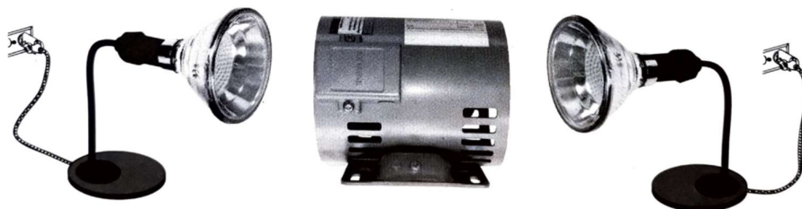
รูปที่ 8.10 การอบขดลวดสแตเตอร์ด้วยหลอดสปอตไลท์
