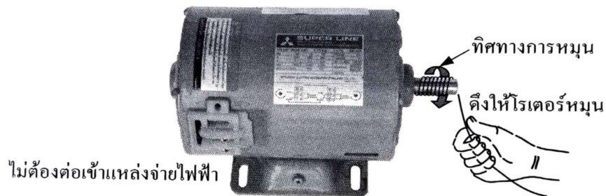
รูปที่ 8.7 ตรวจสอบการเสียดสีภายใน
